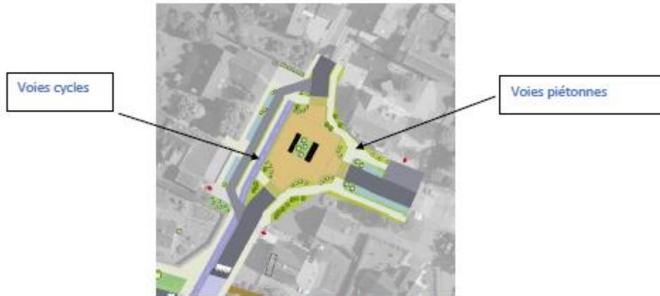
Schéma fonctionnel du giratoire Longrais / Rennes (Esquisse de principe)
